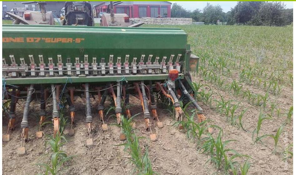
Einbringen von Untersaaten in die Reihenzwischenräume mit einer mechanischen Sämaschine.
